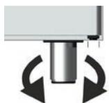
Sistemare il mobile frigorifero in posizione perfettamente verticale, agendo se necessario sulla regolazione dei piedini a vite delle gambe del mobile per regolarne il livello. Verificare la planarità con una livella a bolla.
